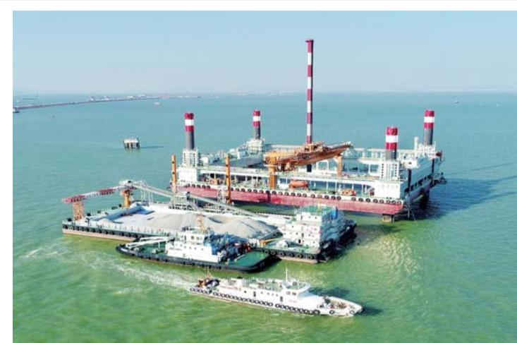
10月14日，“一航津平2”在深中通道西人工岛北侧附近水域完成入场后的首次重载整平试验，各项数据均符合设计要求。
