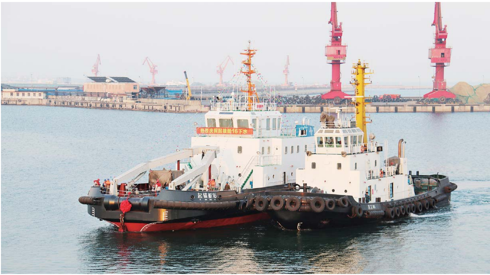
4月2日,由五公司建造的“起锚艇16”顺利下水,该船起锚能力150吨,是公司起锚能力最大的起锚艇。该船全长41.5米,型宽13.2米,型深4.3米,吃水2.9米,建成后将用于深中通道沉管隧道项目。 樊叶颖 张贤臣 摄影报道
