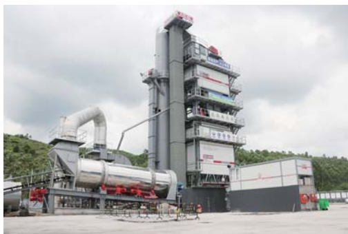
国内最大型号SG5000型沥青拌和站 张阳 摄
