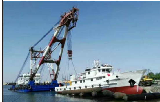
近日,五公司船舶修造分公司负责建造的100T渔政船利用气囊顺利下水。
